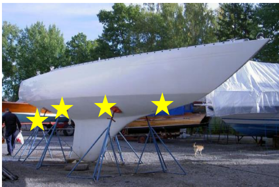
Figur 1. Mätpunkter på båtar mätta av Happy Boat AB. Mätningar utfördes 10-30 cm nedanför vattenlinjen på både styrbord och babord sida enligt bilden (styrbord bak, styrbord mitt, styrbord för, babord för, babord mitt och babord bak plus ömse sidor av rodret). På motorbåtar utan roder mäts på akterspegeln och på snipor mäts på drevstocken.
